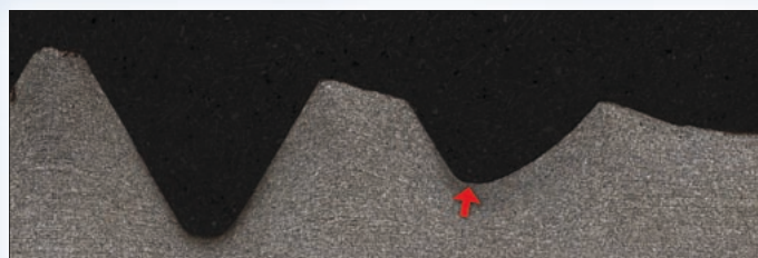
Werkstück mit verrundetem Gewindeeinlauf – kerbwirkungsfreie Gewindeenden Workpiece with rounded thread run-in area – thread ends without notch effect
